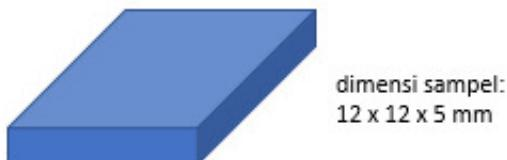
**Figure 7.** Sampel atau benda kerja untuk dinitridasi
