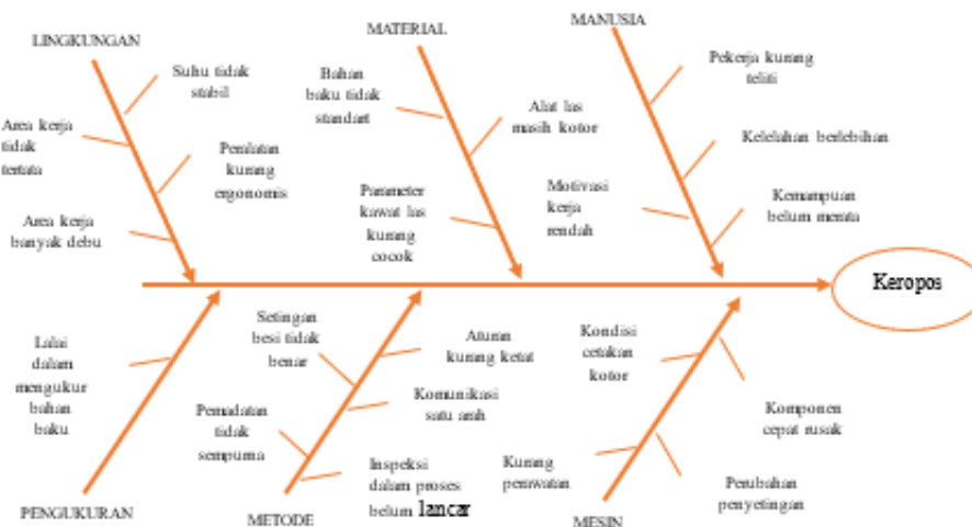
Figure 9. Diagram Sebab Akibat (Diagram Fishbone) pada Jenis Cacat Keropos
