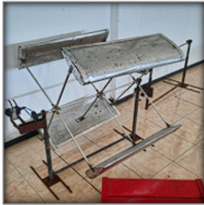
Figure 4. Alat Wind Turbin Menggunakan Blade NACA 0021
