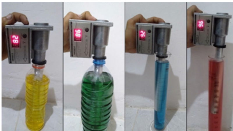
Figure 1. Pengukuran nilai oktan pada bahan bakar premium, pertalite, pertamax dan pertamax turbo
