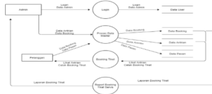
Gambar. 2. DFD Level 1 Perancangan Sistem
