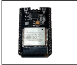
Gambar 2.2 Bentuk Fisik NodeMCU ESP32[7]
