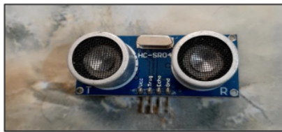
Gambar 2.4 Bentuk Fisik Ultrasonik HC-SR04
