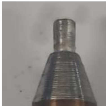
Gambar 4.12 Alat pahat dengan bahu cembung yang memiliki derajat kemiringan lebih kecil dari garis vertikal
