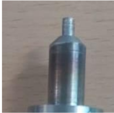
Gambar 4.10 Alat pahat dengan bahu cembung yang memiliki derajat kemiringan besar dari garis vertikal
