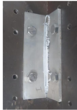
Gambar 4.16 Hasil pengelasan dengan penempatan pin yang menyimpang ke kiri
