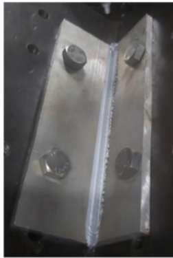
Gambar 4.15 Hasil pengelasan dengan penempatan pin yang tepat
