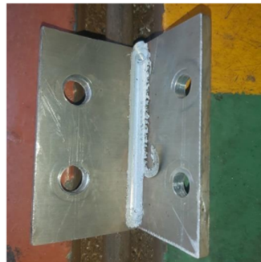
Gambar 4.13 Hasil pengelasan optimal namun masih terdapat chips pada bagian retreating side
