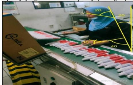
Gambar 4. Packing Setelah Menggunakan Alat Bantu Kerja
