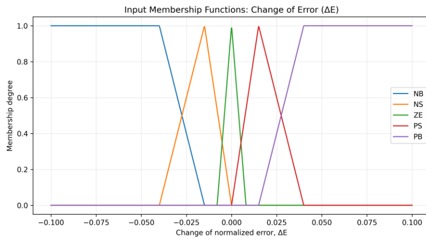
Gambar 3. Fungsi keanggotaan input perubahan error \Delta E .
