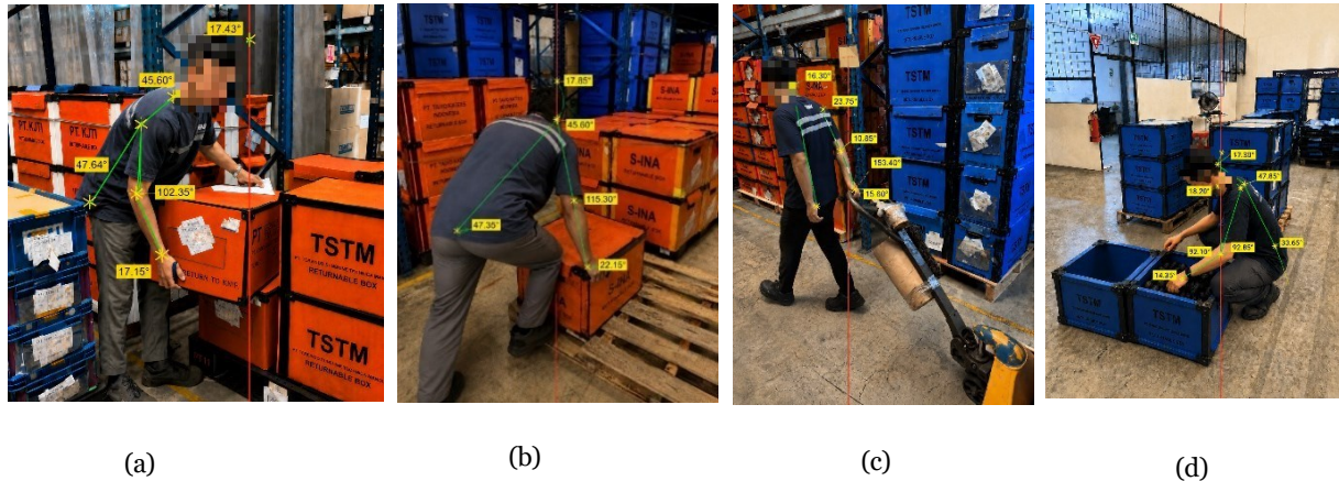
Gambar 1. Postur Kerja pada Aktivitas Picking : (a) Pengambilan barang dari rak; (b) Pemindahan barang ke pallet; (c) Pemindahan hand pallet menuju staging area ; (d) Repacking .
