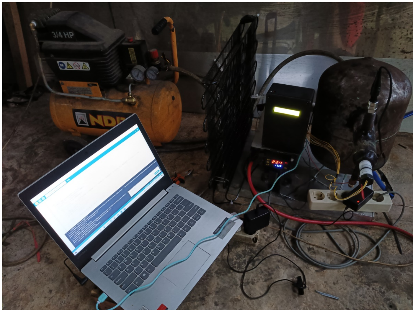
Figure 6. Penempatan perangkat monitoring air dryer kompresor
