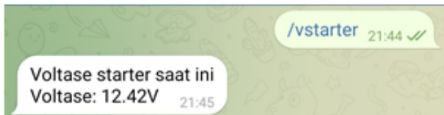
Figure 15. Notifikasi Starter Kondisi Ada Tegangan
