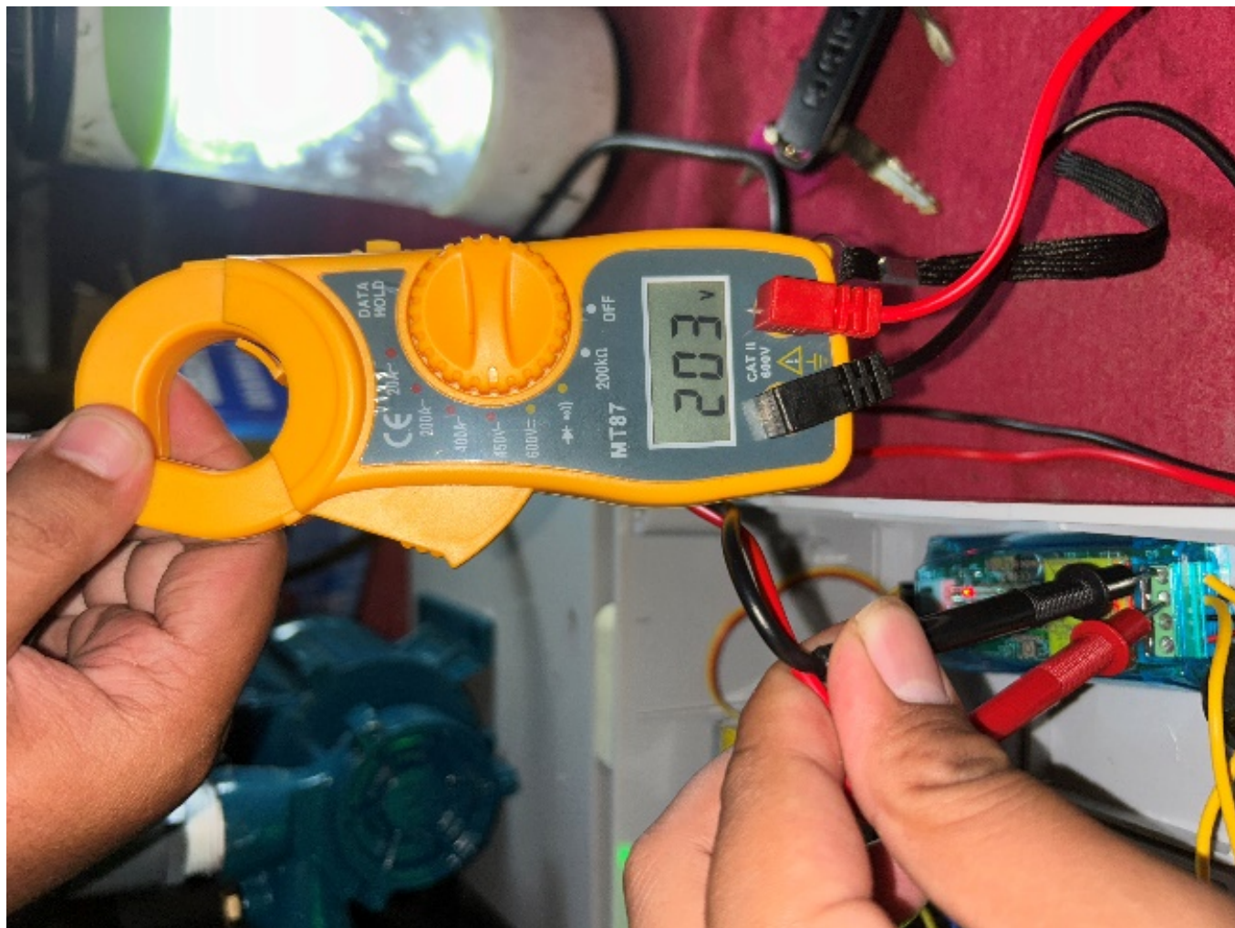
Figure 7. Pengujian Tegangan Menggunakan AVO Meter
