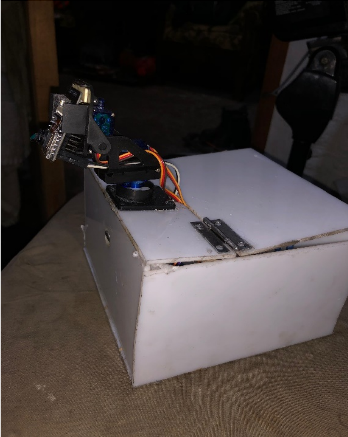
Figure 4. Hasil realisasi alat pendeteksi kebisingan
