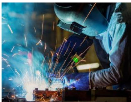
Gambar 8. Proses Pengelasan SMAW
