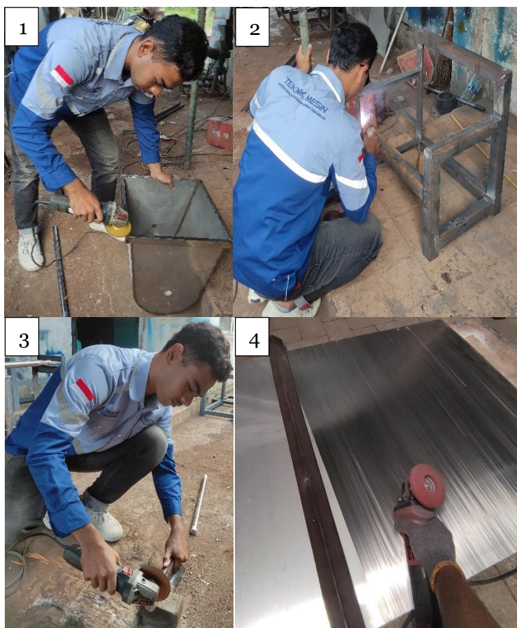
Gambar 3. Proses Manufaktur Mesin Pengaduk Adonan Kerupuk Ikan
