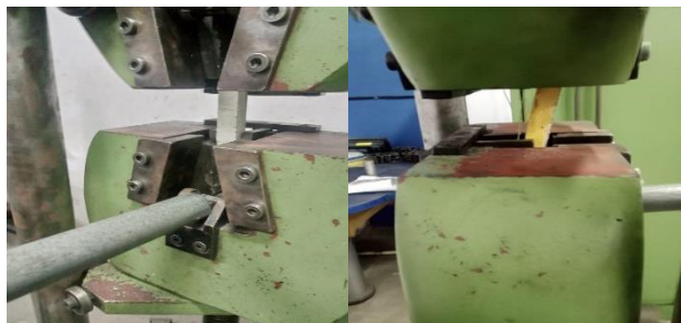
Gambar 5. Sampel Sandwich Panel sebelum dilakukan Uji Tekan dan sesudah dilakukan Uji
