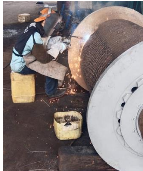
Gambar 2. Proses pengelasan MIG oleh operator
