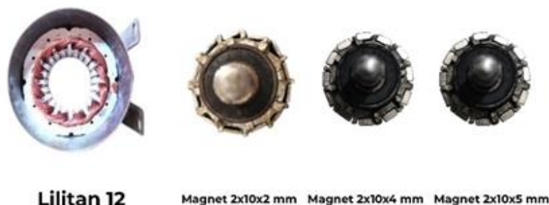
Gambar 2. Kutub Kumparan Pada stator dan Generator setelah dimodifikasi
