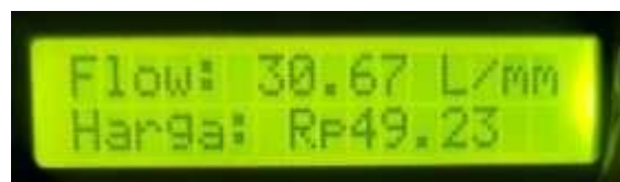
Gambar 7. Pengujian Debit Air pada LCD I2C 16x2
