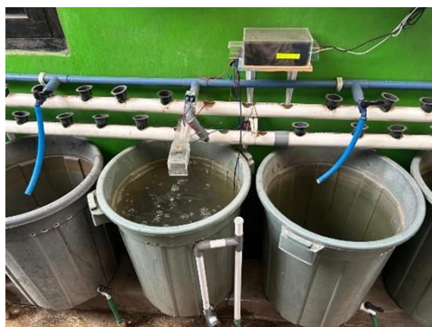
Gambar 9. Implementasi pengurasan otomatis
