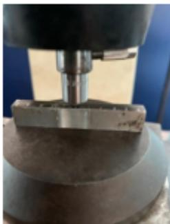
**Figure 25.** *Meletakkan Spesimen Pada Meja Uji*
