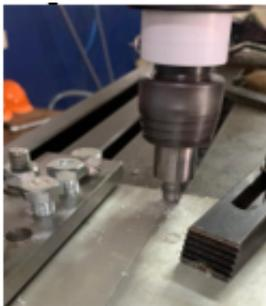
**Figure 13.** *Posisi Shoulder Mendekati Spesimen*
