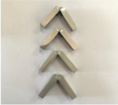
**Figure 18.** *Spesimen Telah Dilakukan Pengujian Impact*
