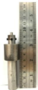
**Figure 3.** *Hasil Pembuatan Tool FSW*
