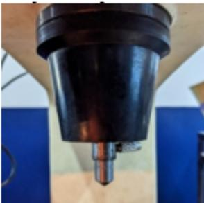
**Figure 22.** *Pemasangan Indenter Pada Alat Uji*
