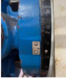
**Figure 11.** *Posisi Setting Kemiringan Mesin*
