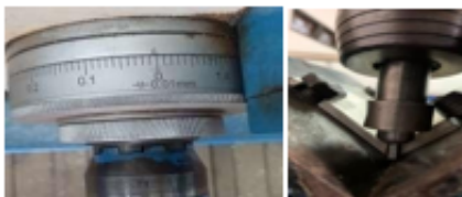
Figure 15. Posisi Tool Shoulder pada titik awal pengelasan
